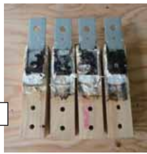
写真 2 腐朽処理後の例
