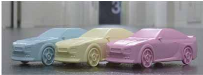
図2 染色したセルロースナノファイバーで補強した樹脂射出成型体（ミニカー）。コットンなどの繊維素材に行われてきた染色技術をセルロースナノファイバーに施すと（カラーナノファイバー）、材料補強とともに材着（樹脂の着色）も同時に行える。
