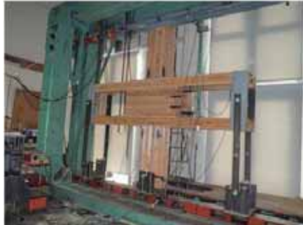
写真5 鋼製反力フレーム
