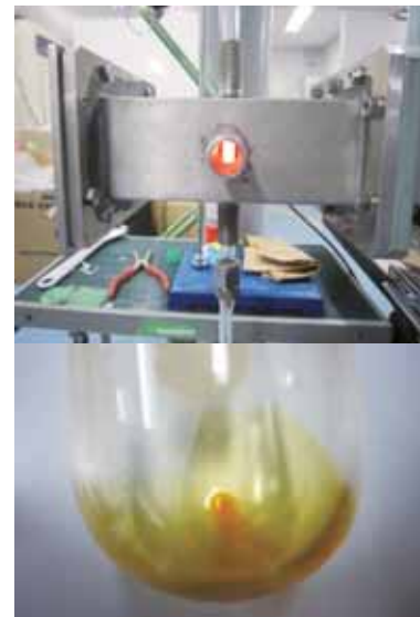
図 2 : (上) マイクロ波熱分解リアクター (下) マイクロ波熱分解油
