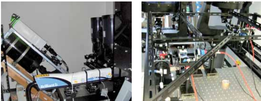
図 本研究で設置した多波長ライダー射出装置（左）と受光装置（右）
