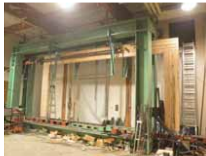
写真5 鋼製反力フレーム
