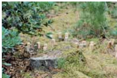
処理杭の野外試験
