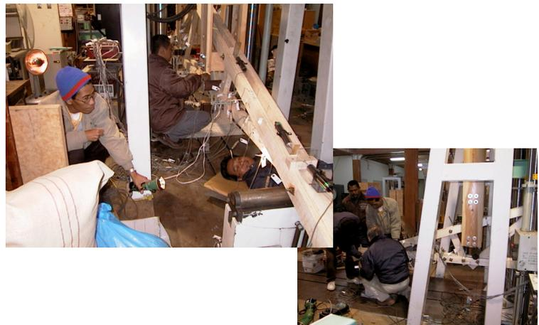
熱帯早生樹材から作成したトラスの強度試験
