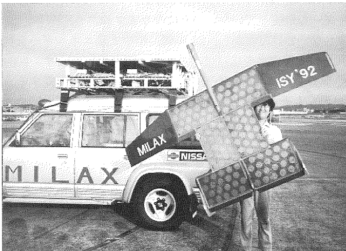
図4 MILAX 飛行機実験(左図)と地上2 定点間マイクロ波送電実験(右図)
