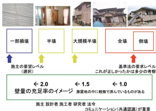
図2 大規模地震の被害と建築法の要求レベル
