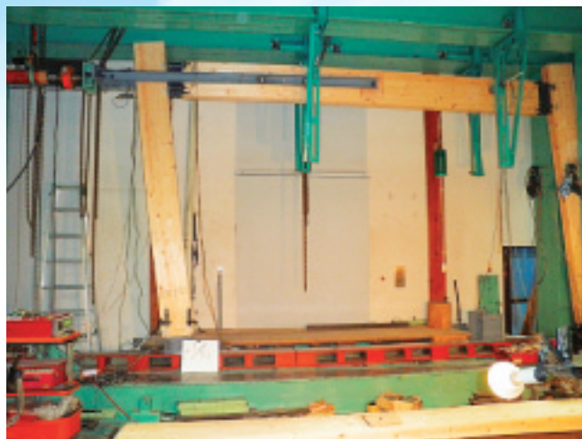
写真1 角度1/10以上変形しても脆い破壊を起こさない 集成材門型ラーメン
