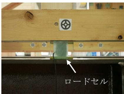
写真 4.6.1-1 試験体重量の測定
