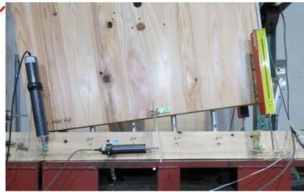
HD金物とほぞパイプの回転引張試験(要素試験結果の参照)
