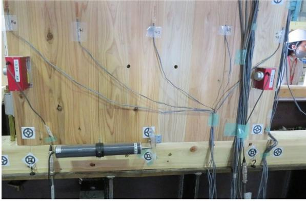
(a) CLT 耐震壁脚部
