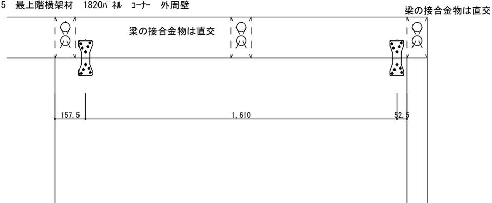
10kN L字(床負) 8 10.4kN、フレート5 10.3kN、ホゾパイプ 1 11.1kN
