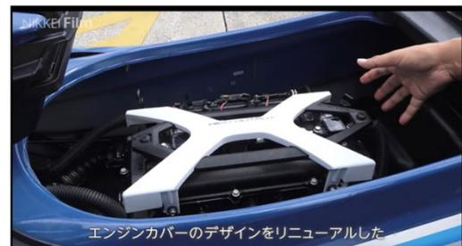
図6 ヤマハ発動機が水上バイクのエンジンカバーに日本製紙（株）が京都プロセスで製造したCNF強化PPを採用（移動体へのCNF材料実装は世界初）
