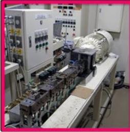
小型2軸混練押出機
