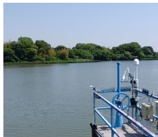
オープンパス型メタン濃度計・二酸化炭素濃度計などを用いた兵庫県加古川市のため池における連続観測の様子
