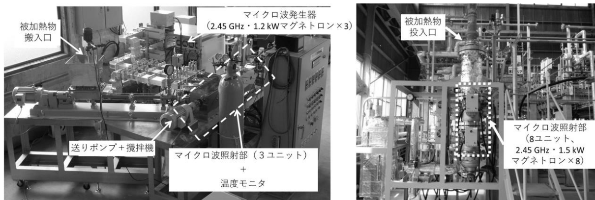
図4：木質バイオマス前処理用マイクロ波加熱装置の写真。（左：マイクロ波出力1.2 kW×3ユニット、右：マイクロ波出力1.5 kW×8ユニット、容量50L）
