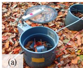
図 4：動的閉鎖式チャンバー法による分解呼吸速度の連続測定風景 (a) 土壤に設置した開閉式自動チャンバー (b) チャンバーのガスラインを切り替えるための電磁弁
