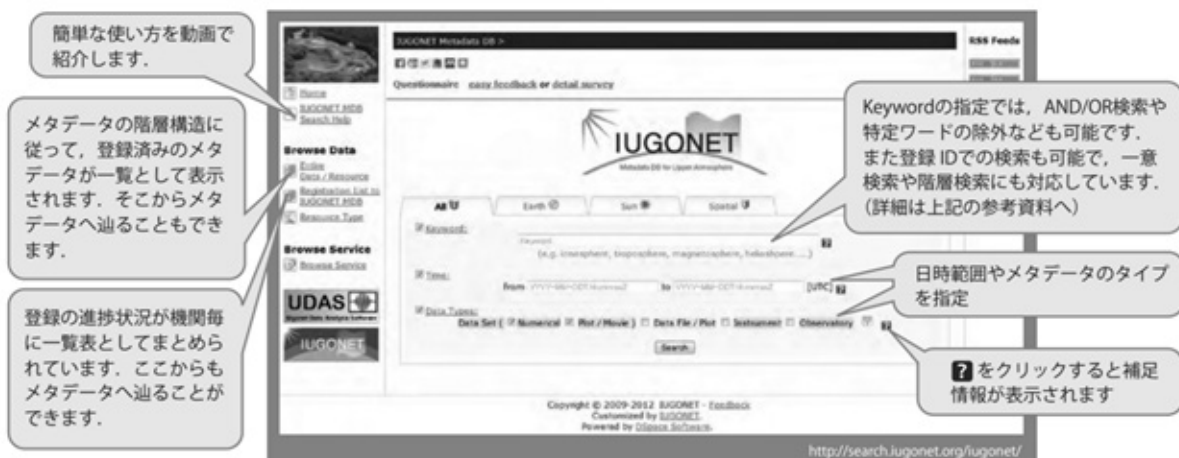
図 5: IUGONET メタデータ検索ページのトップ画面 2) 。検索に必要な入力事項や活用方法などの説明が吹き出しの中に記述されている。
