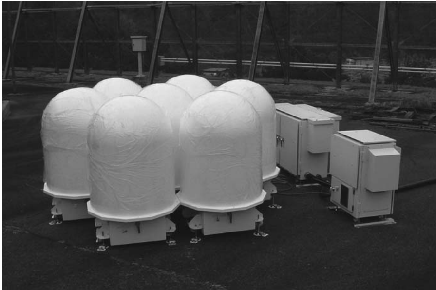
図 1. 信楽 MU 観測所に設置の境界層レーダーLQ7
