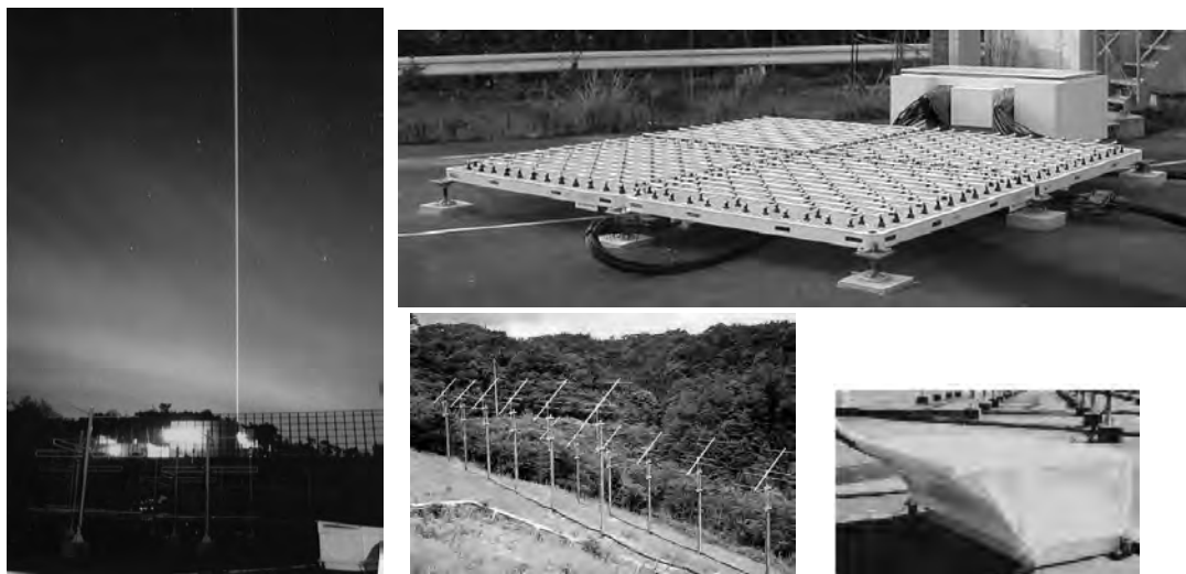
図 2： 信楽 MU 観測所に設置されたレイリー・ラマンライダー (左)、下部対流圏レーダー (右上)、下部熱圏プロファイラレーダー(LTPR)(下中)、RASS スピーカー(下右)
