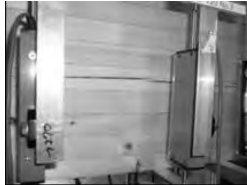
写真7: 割裂破壊の様子
