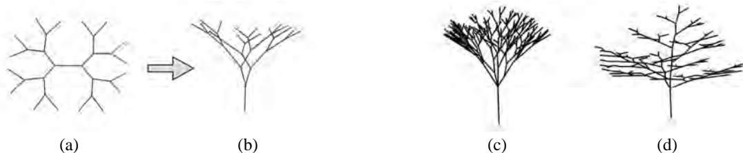
図5：2分岐モデルによる樹形シミュレーション 3) 単に2分岐させた線分の集合 (a) に立体的な角度をつける (b) と樹木らしく見える。さらに線分を増やして浅い角度をつける (c) とケヤキっぽく、同じ線分集合の角度を広げるだけ (c) でサクラっぽく見える。
