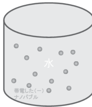
目に見えないナノ(nm)粒径の空気が水に含まれる事で、 表面張力低下機能 浸透性&濡れ性向上機能 が見込まれる。
