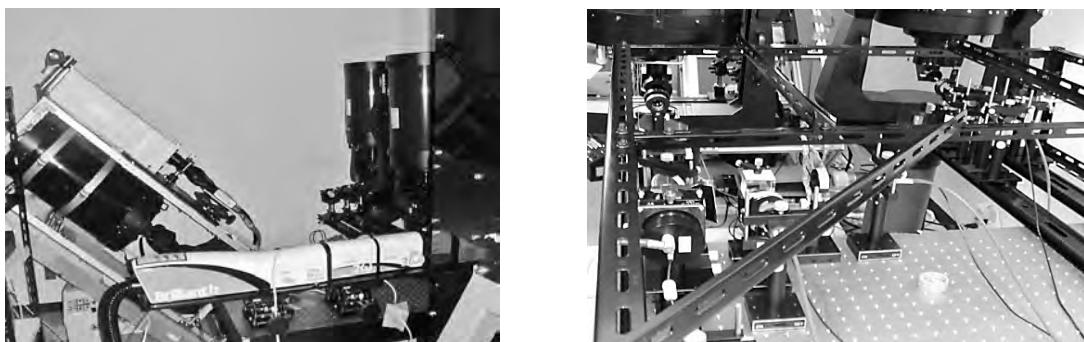
図 本研究で設置した多波長ライダー射出装置（左）と受光装置（右）
