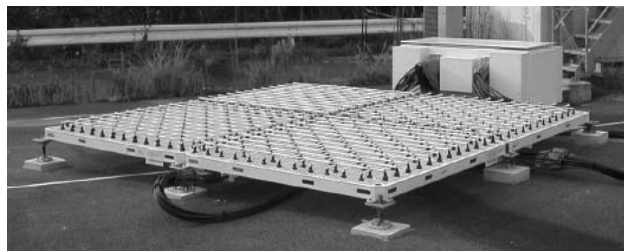
図 3: 下部対流圏レーダーのアンテナ。
