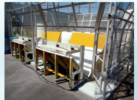
開発中のRASS用パラメトリックスピーカー(手前)。奥はLQ-7大気レーダー
