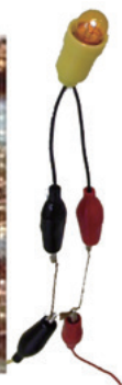
図 1：導電性繊維：超臨界二酸化炭素を用いて繊維表面に金属クラスターを形成させ、その後無電解メッキにて銅薄膜を形成。金属クラスターが繊維表面より数 \mu\text{m} 打込まれるアンカー効果により銅薄膜の剥離強度が向上。抵抗値 0.01 \Omega/\text{cm}
