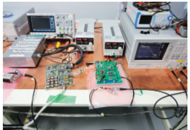
図3：生存圏研究所で試験中の電場・電波観測装置 (Engineering model)
