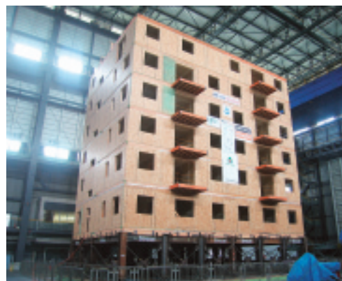
写真2 日米共同研究で実施した木造7階建て振動台実験
