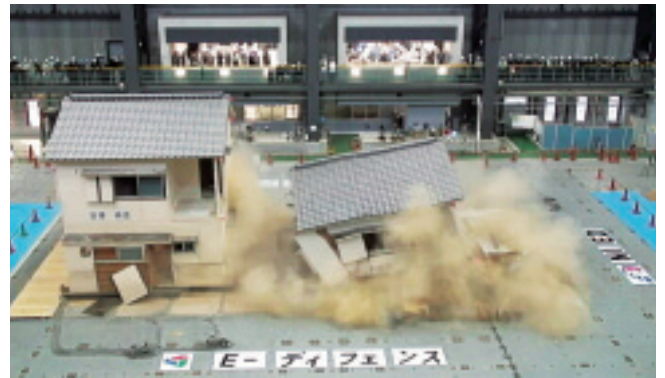
写真1 旧基準で建てられた住宅とそれを補強した住宅の振動台実験
