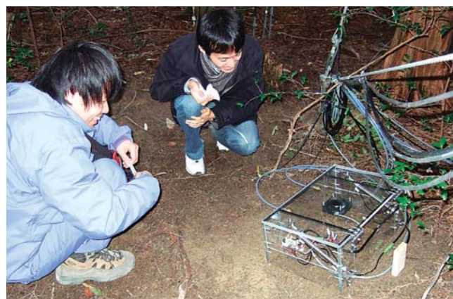
土壌と大気間のガス交換フラックスを測定する自動開閉チャンパーの設置作業。
