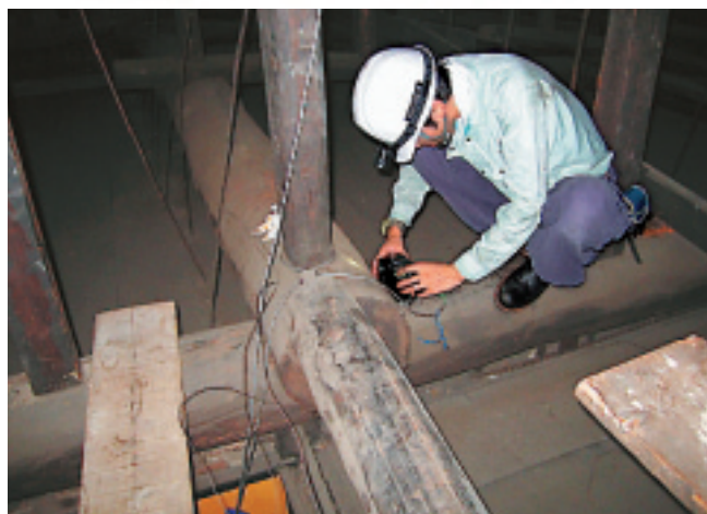
写真1：屋根裏に潜り梁の上に精密な速度計を設置する 清水秀丸防災科研 研究員
