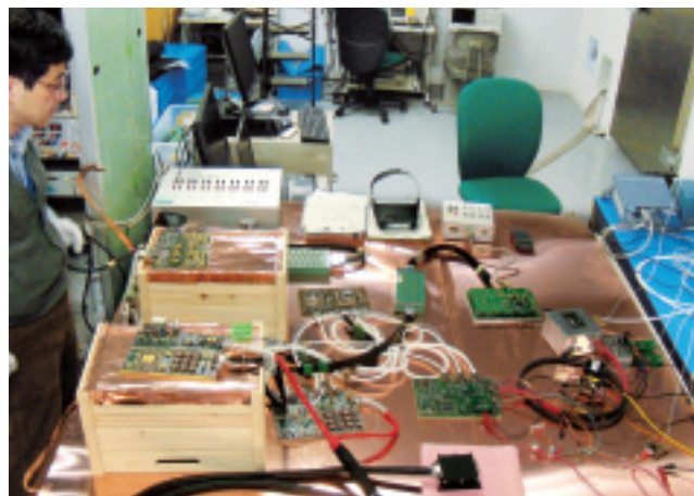
写真1: 机上で複雑にケーブル接続されている各観測ボード
