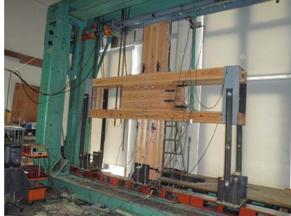
写真5 鋼製反力フレーム
