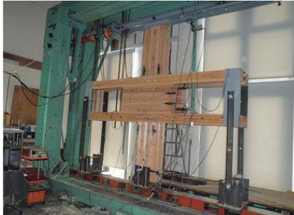
写真5 鋼製反力フレーム
