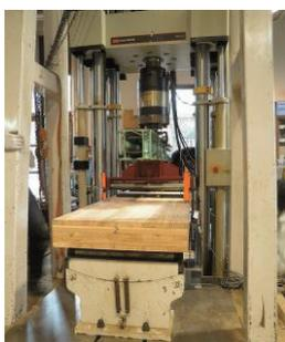
写真4 縦型油圧試験機
