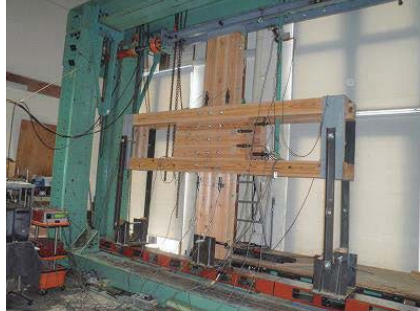
写真5 鋼製反力フレーム
