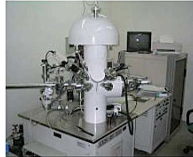
写真6 X線光電子分析装置
