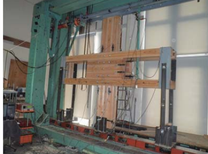
写真5 鋼製反力フレーム
