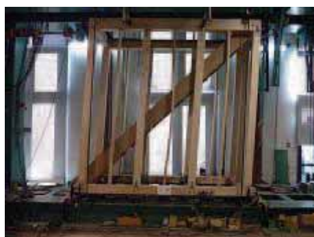
写真9 階段 Box の水平加力実験
