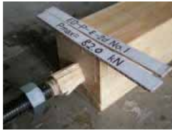
(左) 繊維平行方向 (右) 繊維直交方向 写真 10 GIR 接合の破壊形態
