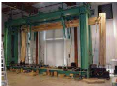
写真5 鋼製反力フレーム実験装置
