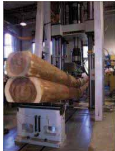
写真4 1,000 kN 縦型サーボアクチュエーター試験機を用いた京都府木橋用スギ丸太2層接着重ね梁の曲げ破壊実験の様子
