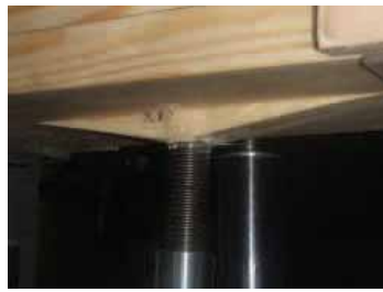
(左) 繊維平行方向 (右) 繊維直交方向 写真 10 GIR 接合の破壊形態
