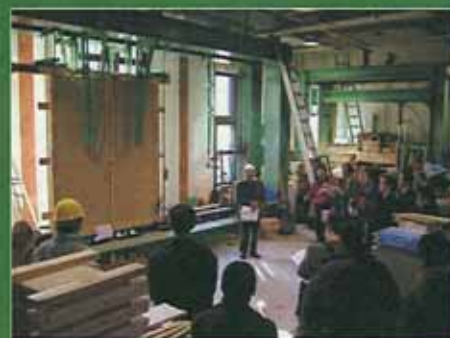
大型反力フレーム
