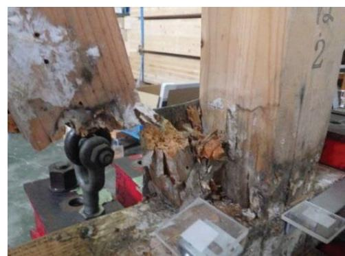
写真 2 筋かいの引張破壊
