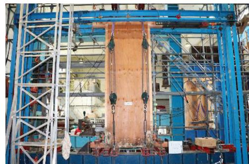
写真 1 耐力壁のせん断実験の様子
