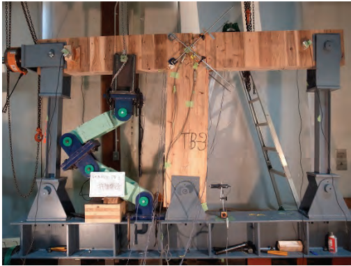
図2：CLTの接合部実験
