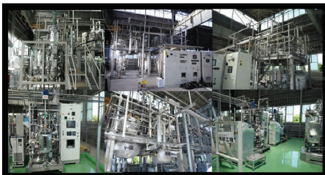
図 10.2.2.4 NEDO プロジェクトで開発したバイオエタノールベンチプラント
