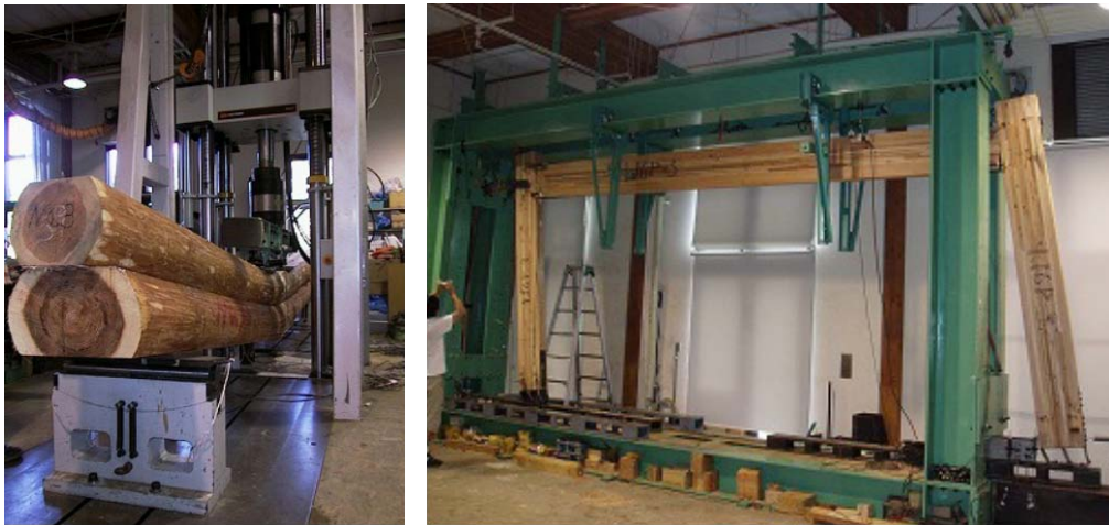
図 2.8 実大耐力実験装置
