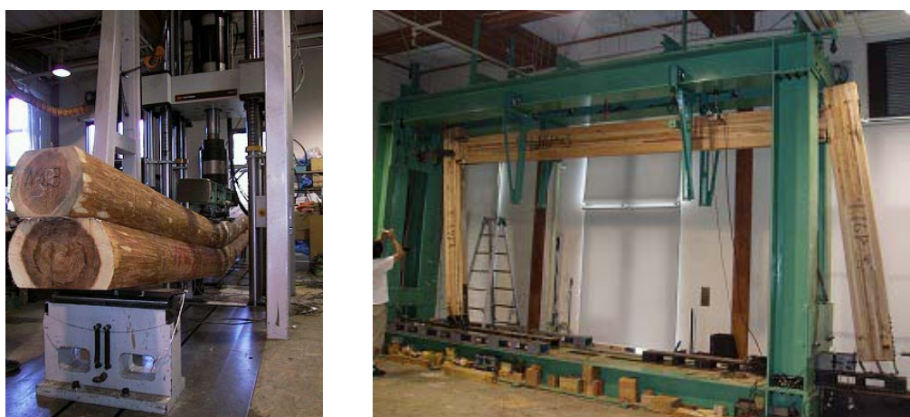
図 2.8 実大耐力実験装置
