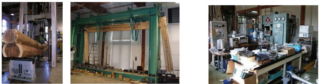
図 7 実大耐力実験装置(左:1000kN サーボアクチュエーター、右:300kN 反力フレーム)
