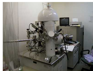
写真2 新規木質系複合材料の開発実験(上)、X線光電子分析装置(ESCA)
