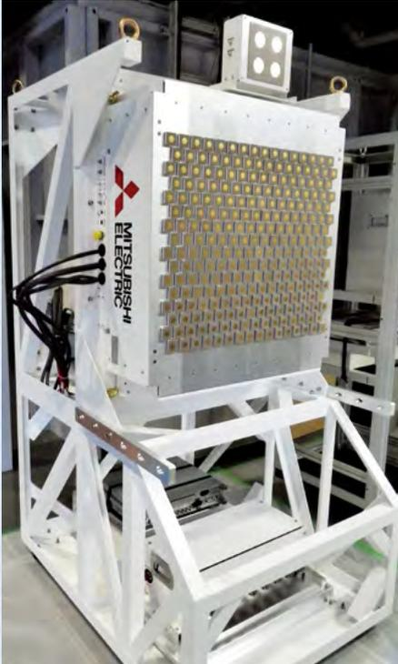
A-METLABは、34m(L) × 21m(W) × 10m(H)の建物内に設置された18m(L) × 17m(W) × 7.3m(H)の電波暗室と、10mφ、10t、10kWのフェーズドアレイを測定可能なplane-polar型の近傍界測定装置で構成されます。暗室には1W/cm<sup>2</sup>に耐える電波吸収体をそなえ、class 100,000のクリーンブースとしても利用できるので、直径10mの人工衛星に関する実験も可能です。高度マイクロ波電力伝送用フェーズドアレイ・受電レクテナシステムは、世界最高性能のマイクロ波エネルギー伝送用フェーズドアレイとレクテナアレイです。レトロディレクティブ、REV法、PAC法、並列化法などの多様な目標推定手法とビームフォーミング手法をそなえ、さまざまなビームフォーミング実験、目標追尾アルゴリズム実験、制御系を利用したアンテナ開発研究、アンテナを利用した回路開発研究、レクテナ実験、無線電力伝送実験が可能です。
