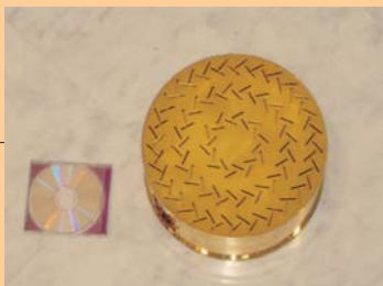
宇宙太陽光発電のための軽量小型マイクロ波送電システム Small and Light Weight Microwave Transmitter for Space Solar Power
