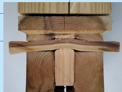
圧縮化した低比重スギ材の込み栓への利用 Use of Compressed Low density Sugi as a Peg
