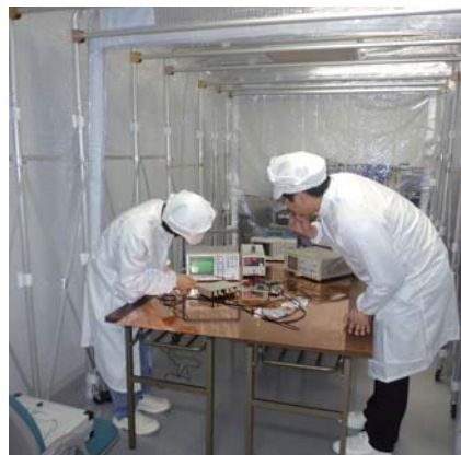
電磁シールドルーム（外側）内に設置されたクリーンブース（Class 10000） Clean booth (Class 10000) located inside the outer shield room.
