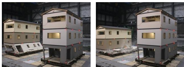
3 階建て実大木造住宅の振動台実験
