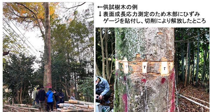
図 3-1：立木の表面成長応力測定の様子
