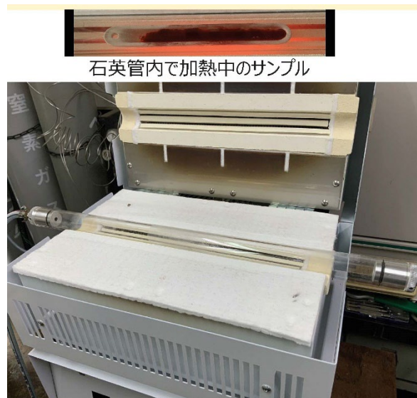
図 5：木質ペレット由来ガス化残渣の賦活による活性炭の製造
