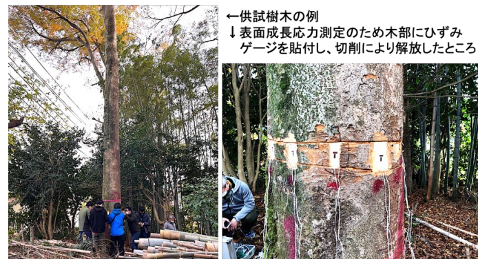
図 3-1：立木の表面成長応力測定の様子
