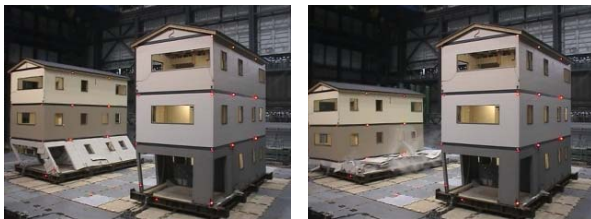
3 階建て実大木造住宅の振動台実験
