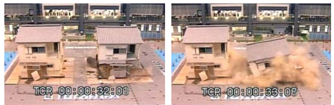
2 階建て実大木造住宅の振動台実験
