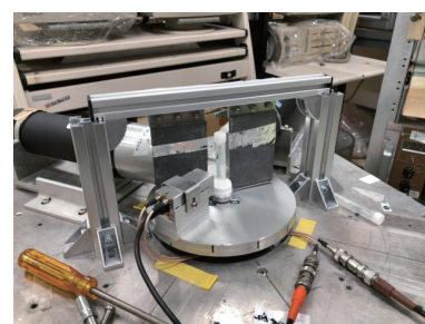
図4： \gamma - \gamma 摂動角相関法を用いたXeウルトラファインバブルの内圧測定の様子
