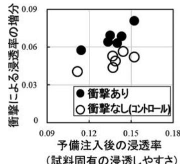
図4：衝撃圧がベイヒバへの液体浸透に及ぼす影響
