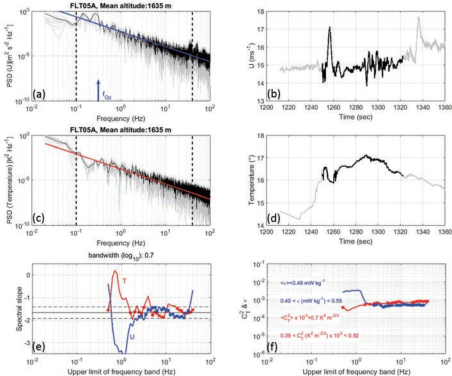
図1：UAV によって高度1635m 付近で観測された「強い乱流」の事例。(a) 風速の周波数スペクトル。青線は $-5/3$ 乗の勾配を示す。(b) (a) に対応する風速の時系列データ。(c) 気温であることを除いて (a) と同じ。(d) 気温であることを除いて (b) と同じ。(e) 最大周波数  $f_{max}$  に対する風速 (青線) と気温 (赤線) のスペクトル勾配。水平の実線と破線は、それぞれ $-5/3$ と $-5/3 \pm 0.25$ の勾配を示す。(f)  $f_{max}$  に対する  $\varepsilon$  (青線) および  $C_T^2$  (赤線) の推定値 (論文のFigure2)。
