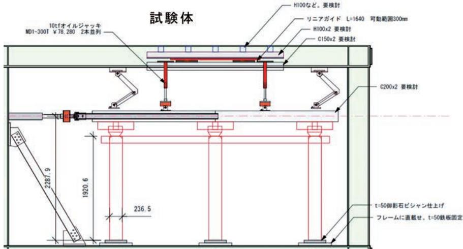
図2：軸力をかけた丸柱+斗組の実験
