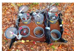
図1. 落葉層分解呼吸の連続測定風景
