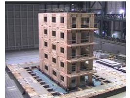
5階建て木造建築の振動台実験
