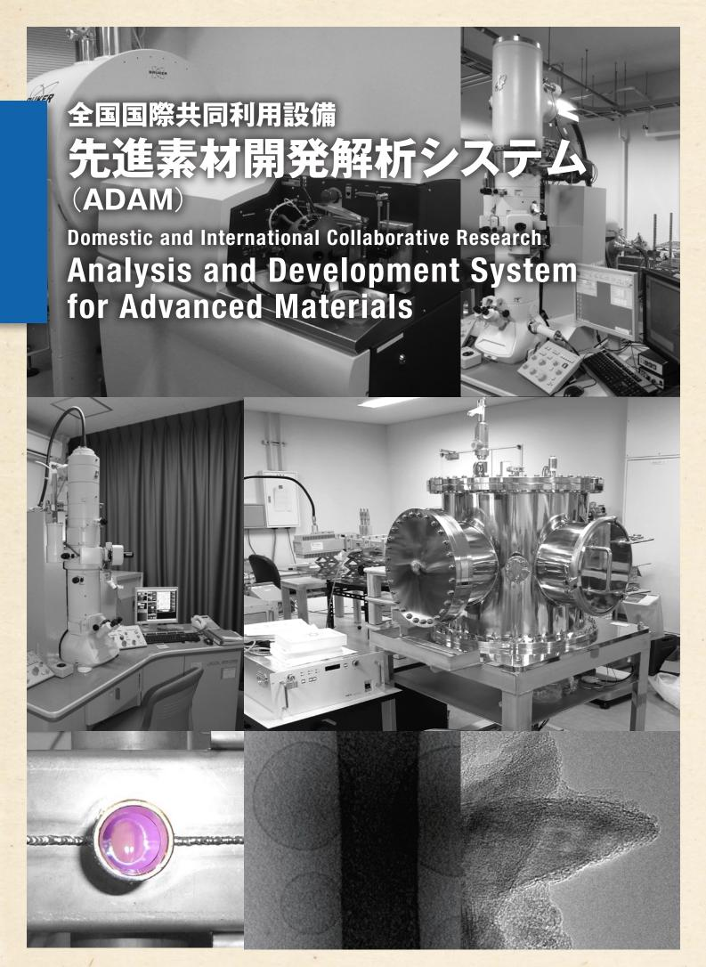
ADAMは、マイクロ波プロセッシング科学の発展と新材料開発に関する研究を支援することを目的に、平成23年度から共同利用を開始した設備です。マイクロ波アプリケータや大電力マイクロ波発生装置、マイクロ波測定装置、質量分析器、有機用・無機用の2種類の電子顕微鏡などで構成されています。マイクロ波を利用したさまざまな物質創成や、細胞やタンパク質などの生体物質や木質新材料、無機材料の精密構造解析など、多種多様な先進素材の開発や分析が可能です。
