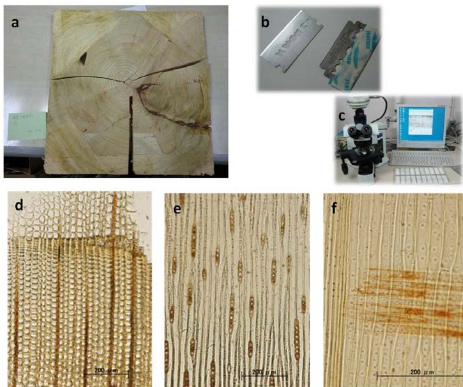
図3：アスナロ属(特に能登半島の建築関係者はそのうちのいくつかをアテ、クサアテ、マアテ、スズアテなどと分けて呼ぶことがあります)の部材(a)を、bのような剃刀を用いて切片を作り、光学顕微鏡cで観察します。d~f(d: 木口面、e: 板目面、f: 柃目面)の顕微鏡写真からそれぞれ解剖学的特徴を見出し同定します。アスナロ属は樹脂細胞があり、分野壁孔はスギとヒノキ型の間で、一分野に三~四個乱雑に存在している点で、似通っているヒノキの組織学的特徴と異なります。なお、樹脂が多いことが多いため組織が見えにくいという特徴があります。
