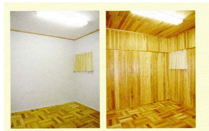
床のみ木造 全面木造 実験に用いたモデルルーム
