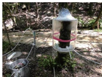
図2：森林土壌および樹幹を介したガス交換フラックス測定用チェンバー
