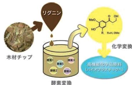
図4：単離リグニンからのフェニルプロパン化合物のワンポット酵素生産と高機能化学品原料への変換
