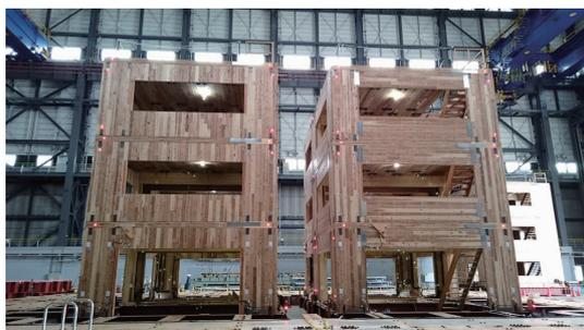
図2：異なる形式の CLT 構造の実験
