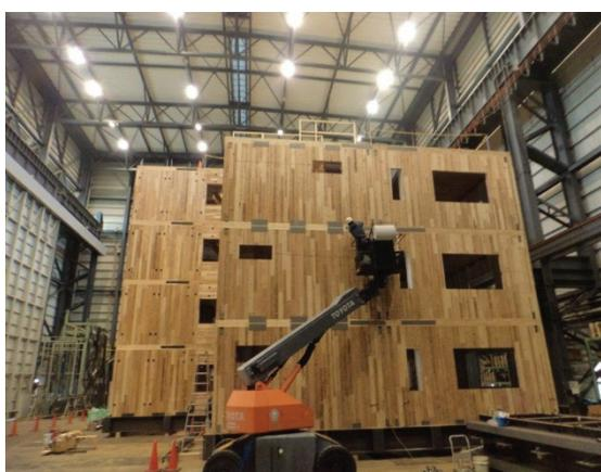
図1：CLT 構造の実大実験
