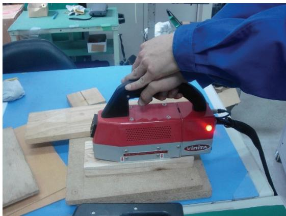
図 4：試作した木材害虫駆除用高周波照射装置による処理(写真提供・飯田高雄氏)
